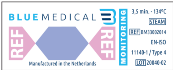
Fehler! Mögliche Ursache: nur Temperatur vorhanden, keine oder unzureichende Dampfdurchdringung / Luftabfuhr.
