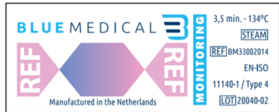
Fehler! Mögliche Ursache: Unzureichende Dampfdurchdringung / Luftabfuhr
