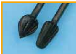
Rost an Bohrem Ursache: Aufbereitung eines Einmalinstrumentes
