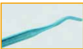
Korrodiertes Füllspatel Ursache: Anbeizung durch sauren Zemententferner
