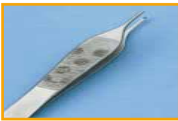
Flecken auf einer Pinzette: Ursache: Unzureichende Dampfqualität
