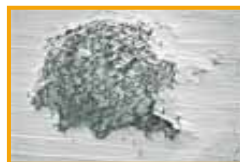
Korrosionsloch – betrachtet unter Rasterelektronenmikroskop – 200-fache Vergrößerung
