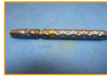
Verfarbter Instrumentengriff aus Titanwerkstoff
