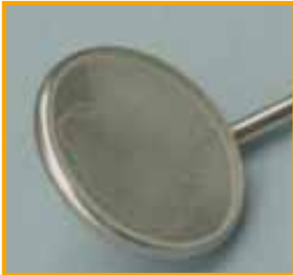
Verfleckungen auf Grund hohen Salzgehalts im Abspülwasser
