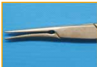
Verformung durch unsachgemäße Handhabung
