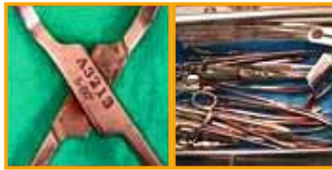
Blutrückstände im Schluss-Gelenkbereich Ursache: Reinigung im geschlossenen Zustand.
