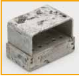
Stark angegriffener eloxierter Aluminiumständer
