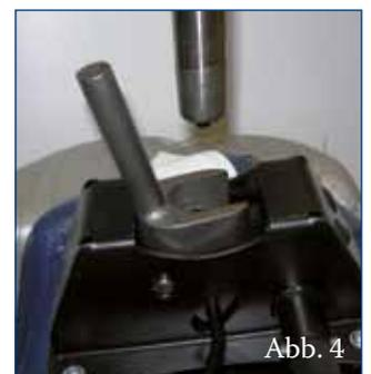
**2. Platzieren Sie den Abstandhalter auf der Höhenverstellung etwa 13 cm unter der Spitze der Stange und fixieren Sie ihn mit einem Inbusschlüssel.**
