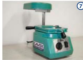
⑦ Drehen Sie das Heizelement wieder nach hinten und lassen Sie den Vakuummotor ca. 40 Sekunden laufen. Warten Sie nach dem Ausschalten des Vakuummotors noch 2 Minuten, bevor Sie den Rahmen öffnen.
