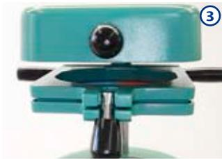
③ Schieben Sie den Rahmen vollständig nach oben. Drehen Sie das Heizelement über den Rahmen.
